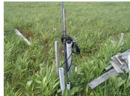
破損した地下水位計(Sutefan15地点:H25年
