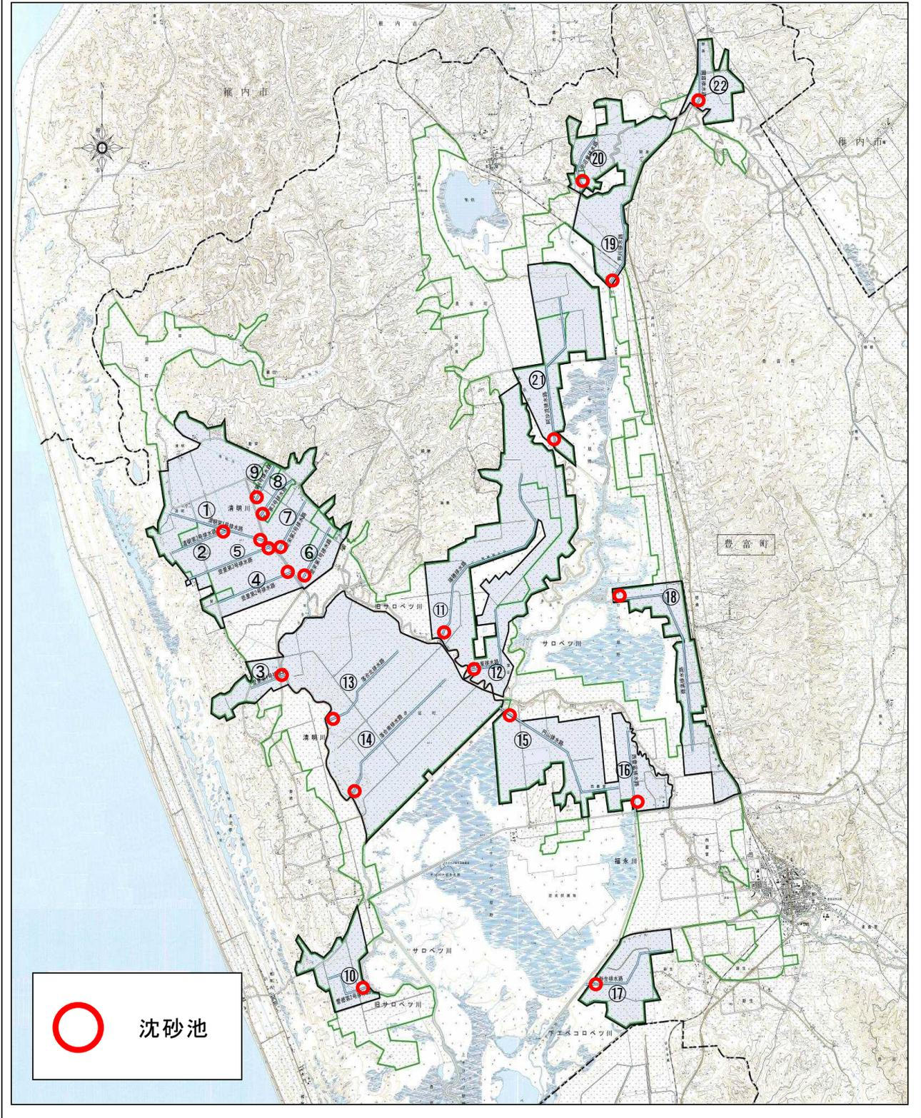
図7 沈砂池設置位置図
